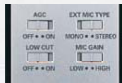
使用頻度の高い機能は、本体背面にハードウェア・スイッチとして装備
