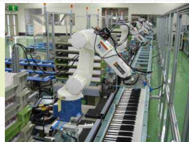
異なる種類の鍵盤を生産可能な「混流ライン」
